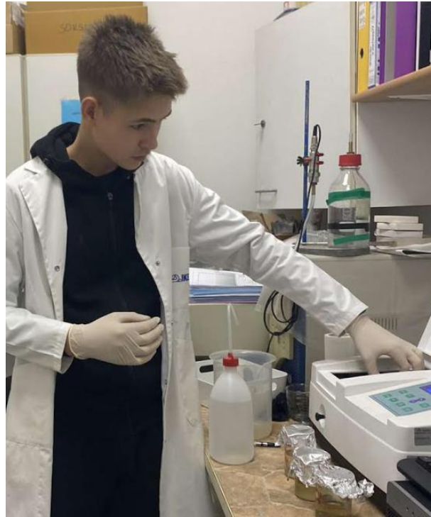
Slika 27: Spektrofotometrična določitev klorofila v vzorcih (vir lasten)
