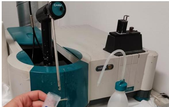
Slika 14: UV - VIS spektrofotometer (Vir: lasten)\*
