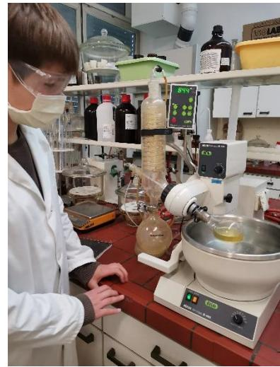
Slika 18: Odstranjevanje topila z rotavaporjem
